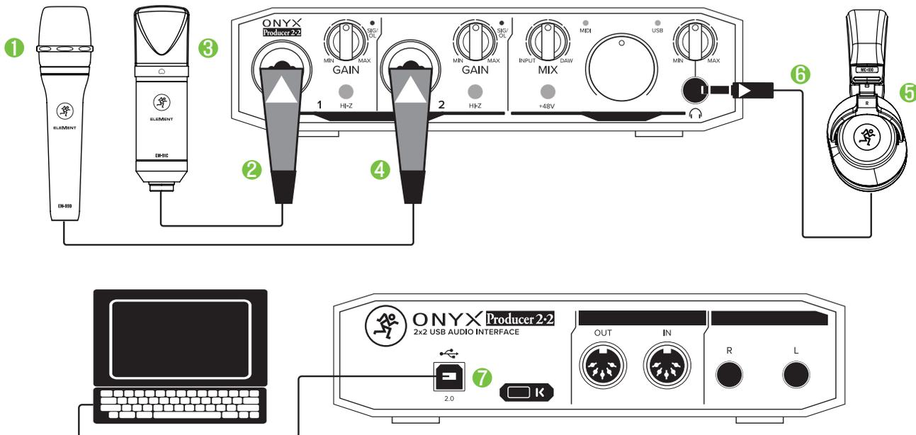
EM-91C コンデンサーマイク①は Onyx 2・2 インターフェイスの Ch.1②に接続され、EM-89D ダイナミックマイク③は Ch.2④に接続されています。Onyx 2・2 のマニュアルをチェックして、ゲインやモニター設定のヒントを入手してください。
